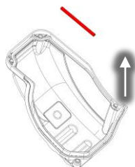
图 1 – 主电源盖板“D”密封件拆除
