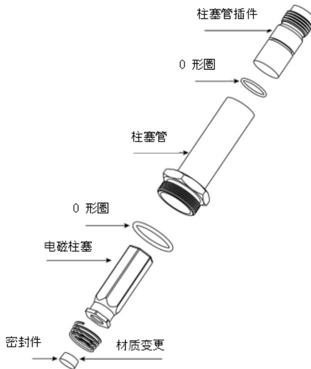
图 1 - 柱塞总成密封位置
