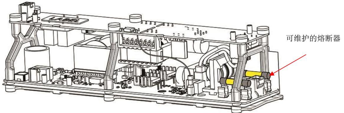
图 1 — 直流-直流转换器的熔断器
